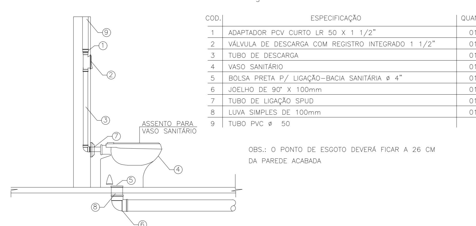
DETALHE DE LIGAÇÃO VASO SANITÁRIO
